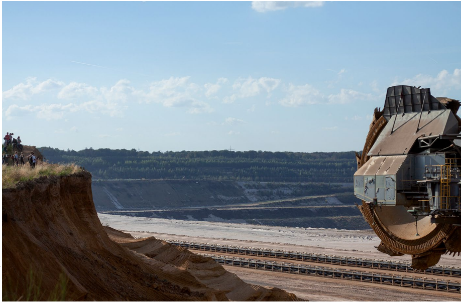
Bild 1: Nach Beendigung des Braunkohleabbaus kann die Stabilität der Böschungen nur gewährleistet werden, wenn mit einer Befüllung mit Wasser ein Gegendruck aufgebaut wird.
